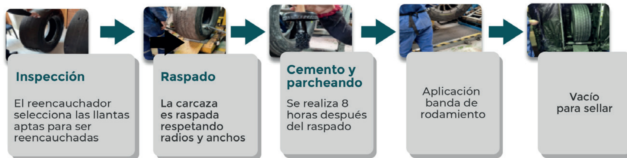
Ilustración 2 Procesos para el reencauche de llantas:
