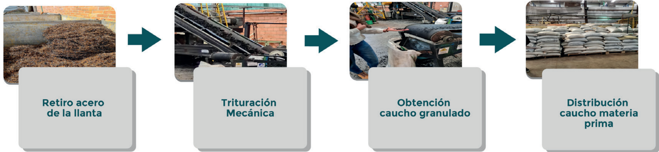
Ilustración 4 Procesos trituración mecánica de llantas para obtención de gránulos de caucho
